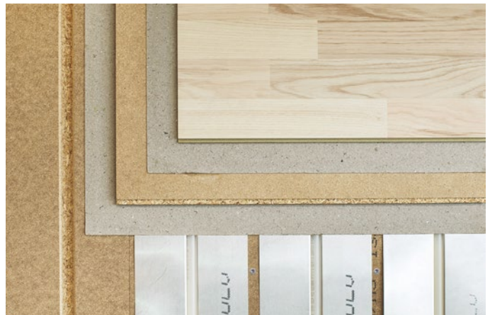
Figur 12 Man skall alltid lägga golvpapp mellan värmefördelningsplattor och undergolvsskivor, samt mellan undergolvsskivor och trägolv för att undvika knarr- och gnisselljud.
